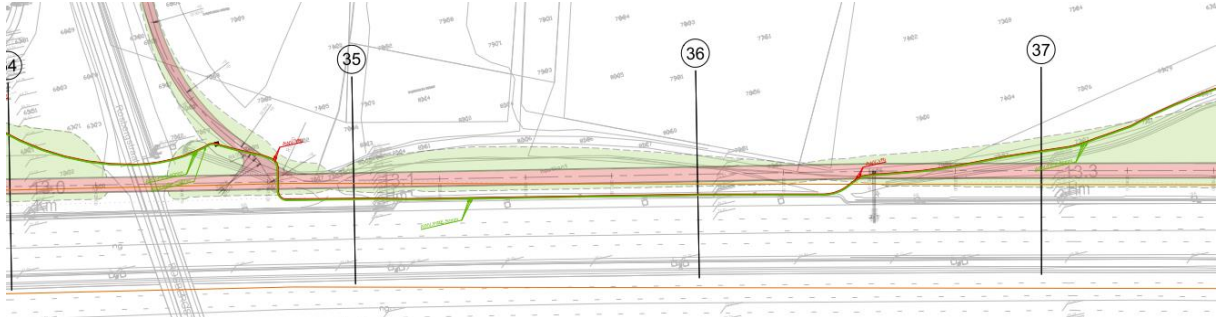
Figuur 10: Voorbeeld van AWW-leidingen die parallel lopen met de fietssnelweg en kruisen op bepaalde locaties (voor profiel 35 en tussen profiel 36 en 37).
